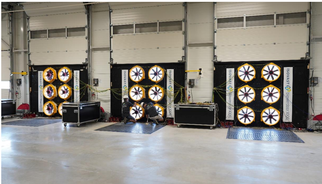
Voorbeeld van een meetopstelling waarbij 18 meetventilatoren zijn gebruikt
